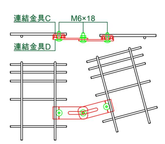
傾斜部取付詳細図 (S=3:1)
